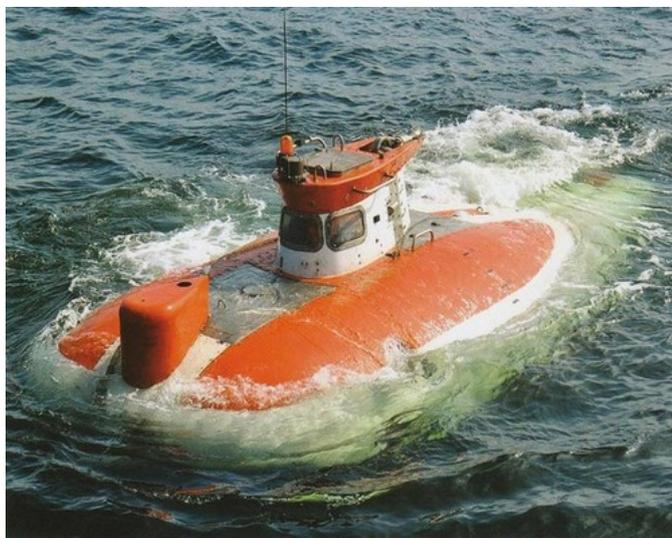
«Консул» - это российский глубоководный обитаемый аппарат специального проекта 16811. Он предназначен для аварийно-спасательных и подводно-технических работ, а также используется при установке на подводные объекты некоторых маяков-ответчиков и для доставки на грунт, подъема на поверхность тяжелого оборудования массой до 200 килограммов. По модернизированному проекту 16810 под названием «Русь» спроектирован второй аппарат.
