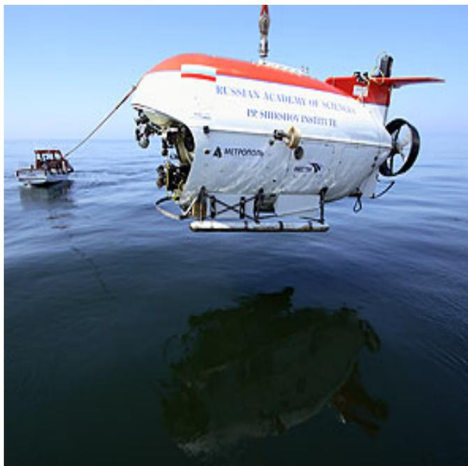
Глубоководный аппарат Пайсис - серия подводных обитаемых аппаратов, разработанная канадскими учеными для океанологических исследований и спасательных работ. Все аппараты этой серии изготавливались из высокопрочной легированной стали. Носовая сфера аппарата Пайсис является обитаемой, в этом и заключалась удивительная особенность этих аппаратов. Обитаемая камера - корпус с тремя иллюминаторами, проходами для проводки и входным люком.
